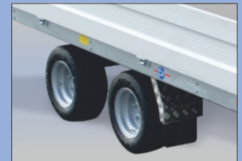
10"- Schwerlastbereifung für niedrige Auffahrhöhe
