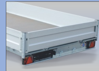
Klappe verhind. d. Herausrutschen d. unterschiedl. Auffahrschienen
